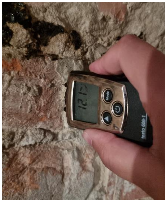
Fot. 4 Pomiar wilgotności muru wewnątrz budynku
