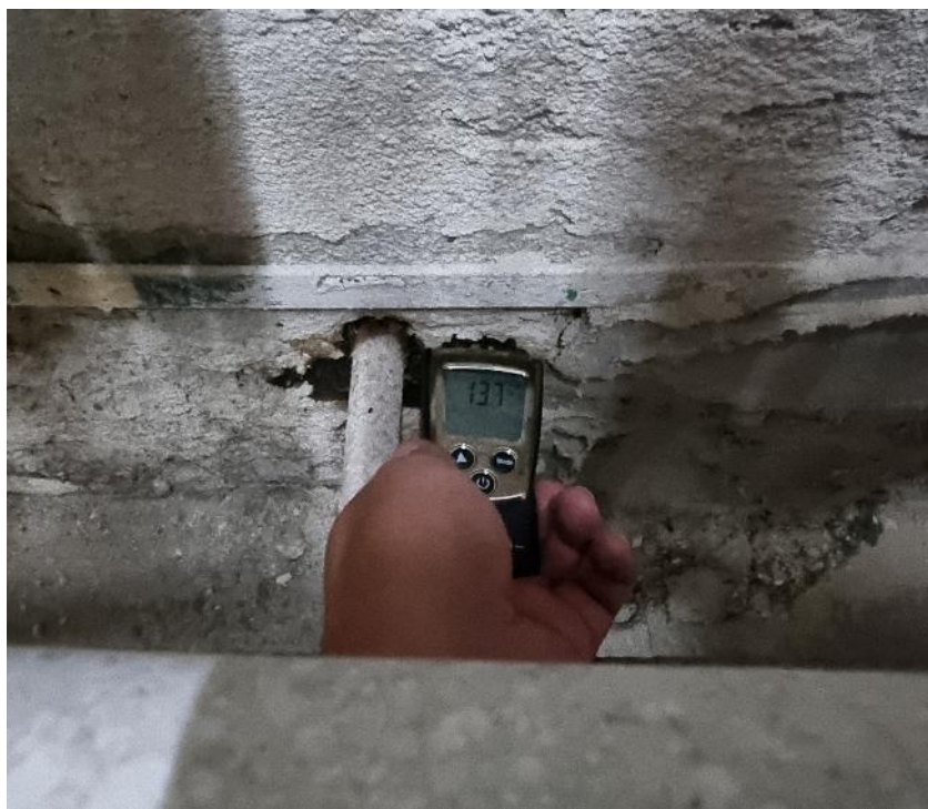
Fot. 4 Pomiar wilgotności muru wewnątrz budynku
