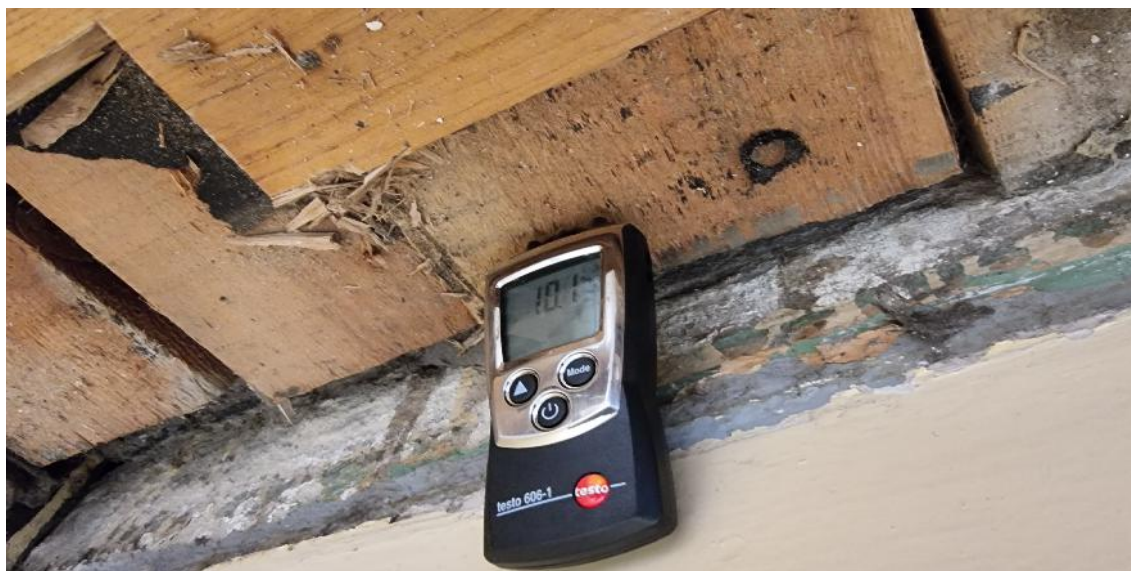
10 Widok odkrywki podłogi w sali gimnastycznej / pomiar wilgotności
